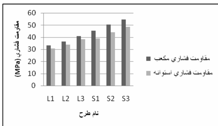
نمودار ۱- نتایج آزمایش‌های مقاومت فشاری بر روی نمونه‌های مکعب ۱۵ سانتیمتری و استوانه استاندارد
