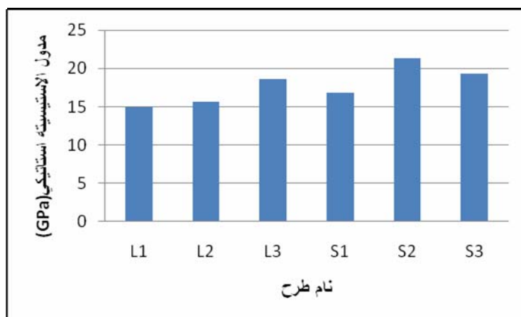
نمودار ۳- نتایج آزمایش مدول الاستیسیته استاتیکی
