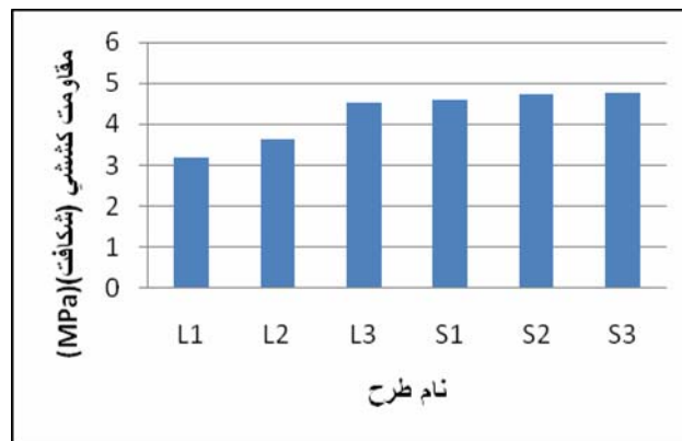
نمودار ۲- نتایج مقاومت فشاری استوانه در مقابل مقاومت کششی (MPa)
