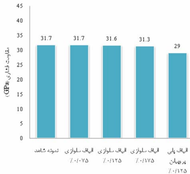
شکل ۵- مقایسه مدول الاستیسیته نمونه‌های حاوی الیاف سلولزی و پلی‌پروپیلن
