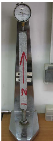
شکل ۴- تصویر یکی از نمونه‌های ساخته شده در دستگاه سنجش تغییر طول
