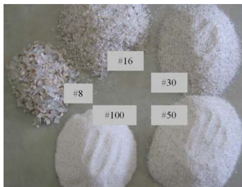
شکل ۲- اوپال دانه‌بندی شده جهت ساخت نمونه‌های ملات منشوری
